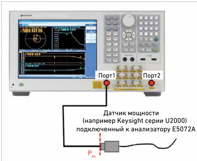
Рис. 9. Калибровка мощности с использованием датчика мощности.
