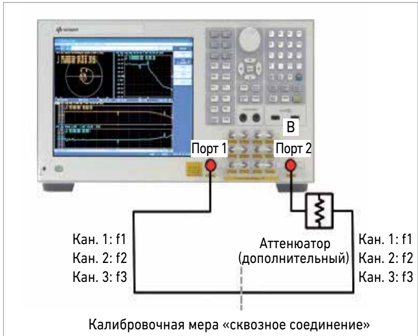
Рис. 19. Схема калибровки приемника в диапазоне частот гармоник.
